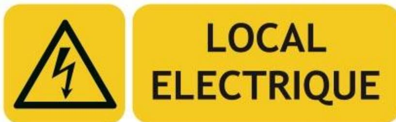
Lors de l'ouverture d'une armoire électrique présentant des pièces nues sous tension accessibles, un balisage de sécurité est installé. Ce balisage ne doit pas pouvoir être franchi par inadvertance. Seul les personnels ayant reçu une habilitation électrique sont autorisés à entrer en contact avec les installations électriques.
